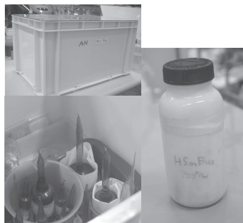
図3 アンプルおよび有機物質を入れてあるコンテナ（左）、コンテナ内部（左下）およびアンプルを入れてある試薬びん（右）。コンテナ上部のふちにシリコンラバーを貼付け、塩化ビニル板のふたをのせている。密閉性を持たせ、蒸気を漏れにくくし、また、破損しやすいアンプル上部を保護している。右写真はプラスチックの試薬びんを切断しアンプルを入れてテープを巻いて止めてある。この物質は保管中に破裂することがある 4) 。
