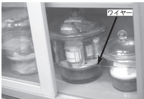
図4 ワイヤーで保護したデシケータ。ワイヤーの両端に棚を固定する金具を付け、取り外しできるようにしてある。
