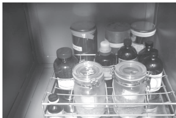
図5 金庫型保管庫内部。手前の密閉容器は有機金属試薬である。また、金属ナトリウム、金属ナトリウムを入れ脱水している有機溶媒および二硫化炭素等の特殊引火物も入れてある。
