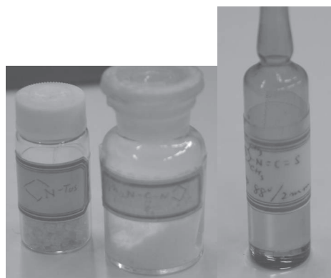
図1 構造式が書かれたラベルのみの試薬。左は合成品、右は市販品を蒸留しアンプルに詰め替えた試薬。
