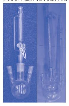
左側に関しては冷却管が取り付けられておらず、また、栓もしていないことで全く理解されずに組み立てられたものである。右側に関しては、ジムロー冷却管が取り付けてあり還流条件を満たす。液体を滴下することに対しては、長い管(実際は減圧蒸留時のキャピラリー用の管である)を通して液体を加えていくと説明していた。
