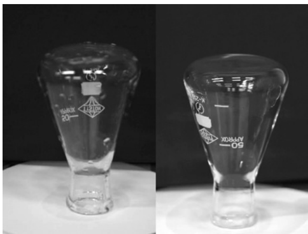
図1 クレンザーで洗う前と後の三角フラスコ。洗う前（左側）は水をはじいて水滴が付着しているが、洗浄後（右側）は均一になっている。ただし、乾燥させると目で見て区別がつかなくなる。クレンザーを落とさないと粉が残る。
