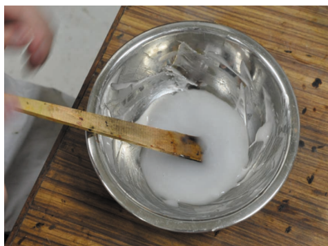
図29 養生に使用した生麩糊
