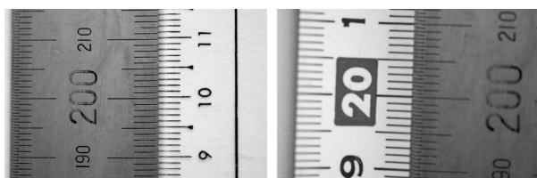
図1 定規、巻き尺の精度の比較
