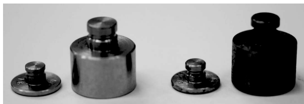
図4 錆の出た分銅の精密天秤での質量の測定
