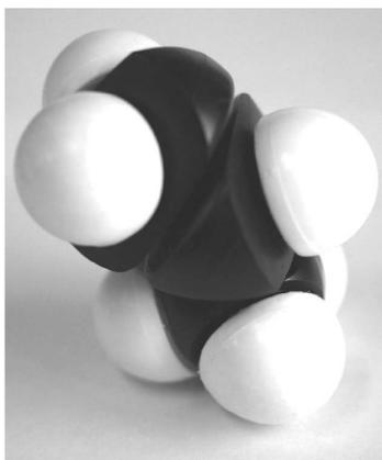
図6 Ealing社CPK Atomic Models（プロペン、拡大率は $1\text{Å}=1.25\text{cm}$ ）
