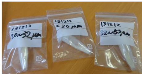
粒径 20\mu\text{m} 以下、 20\sim 32\mu\text{m} 、 32\sim 53\mu\text{m} に調整されたゼラチンハイドロゲル
