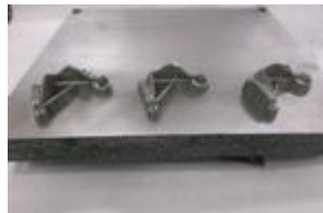
図 17 積層造形により製作したフレームワーク
