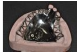
図 19 CAD による設計を行い、積層造形により完成
