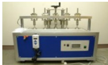
図11 繰り返し疲労試験装置
